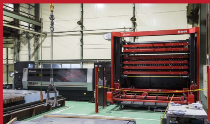
※佐藤担当 アマダ製ファイバーレーザー(6段パレットチェンジャー搭載)
